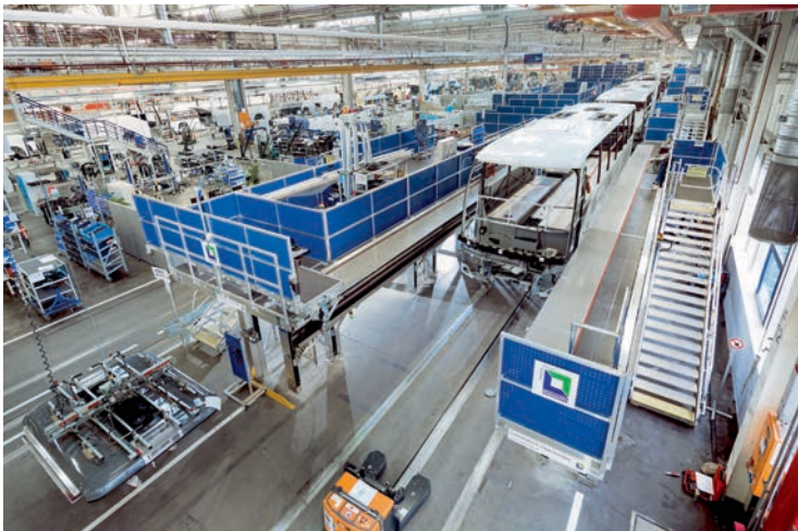
Effizient: Aufdacharbeitsanlagen mit Vormontageplätzen
