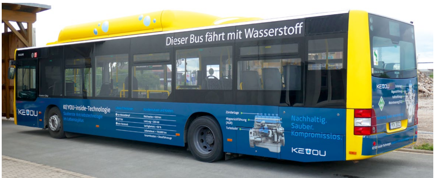
© Dass Wasserstoffverbrennungsmotoren im Bus funktionieren, bewies vor einiger Zeit die BVG auch mit diesem Bus
