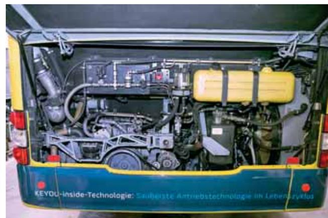
Zu Forschungszwecken hat Keyou zwei Wasserstoffbusse von den Berliner Verkehrsbetrieben (BVG) gekauft. Ihre liegenden Reihensechszylinder H 2876 UH leisten 150 kW (204 PS). Es werden 45 kg Wasserstoff mitgeführt, verteilt auf zehn Flaschen; das reicht für etwa 200 km im Berliner Stadtverkehr. Der ehemalige BVG-Bus 1486 wurde bei Keyou wieder zugelassen, 1488 dient als Reserve und Ersatzteilsender.
