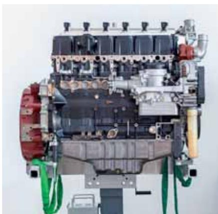
Der Prototyp-Motor von Keyou basiert auf dem Deutz TCD, einem stehenden Reihensechszylinder mit 7,8 l Hubraum. Fotos, soweit nicht anders gekennzeichnet: Keyou, Sarah Walsdorf
