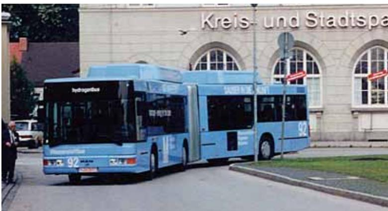
Mit dem liegenden Wasserstoffmotor H 2866 UH mit 140 kW (190 PS) stattete MAN 1998 eine kleine Vorserie aus: Am Münchener Flughafen wurden zwei MAN NG 193 H2 und ein Neoplan N 4421 in Dienst gestellt, die mit gasförmigem Wasserstoff betankt wurden. Das Volumen von 2.580 l Wasserstoff reichte für etwa 150 km. Fotos: Kirsten Krämer, Neoplan
