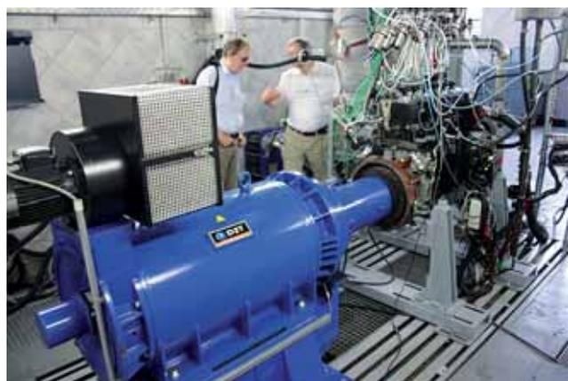
Hochdynamisches Bremsdynamometer (Vordergrund links) und Keyou Wasserstoffmotor (rechts) auf dem Motorenprüfstand bei Adapt in Nordhausen.
