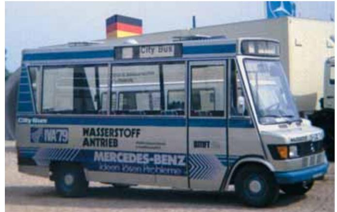
Als völlige Neuentwicklung stellte Mercedes-Benz auf der IVA 79 einen von Vetter aufgebauten Citybus vor, dessen Verbrennungsmotor mit Wasserstoff betrieben wurde. Die Abwärme aus dem dabei erzeugten Wasserdampf wollte man zu 80 % wiederverwenden. Foto: Manfred Schwanke
