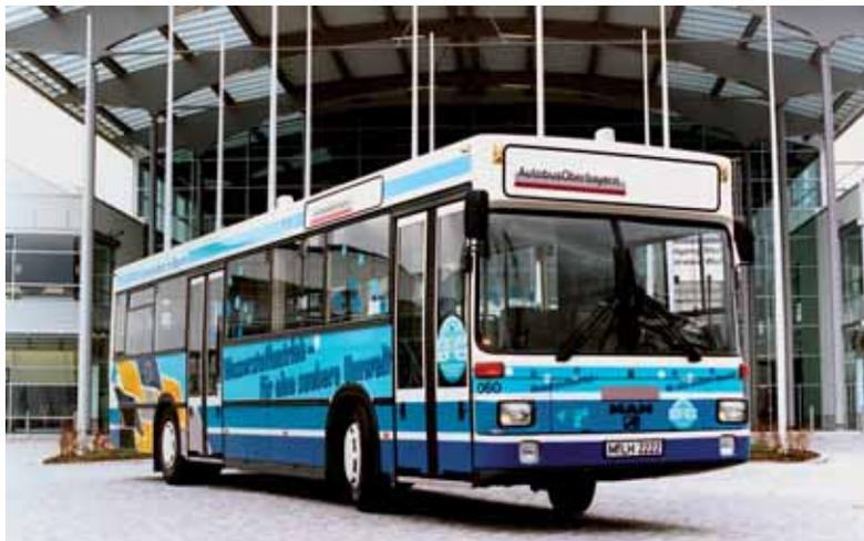
In den 1990er Jahren begann MAN die Entwicklung von Bussen mit Wasserstoff-Verbrennungsmotoren, Ausgangsbasis bildeten die Erdgastriebwerke. 1996 ging in München und Erlangen ein SL 202 LH2 in den Probetrieb, der flüssigen Wasserstoff mitführte. Foto: MAN
