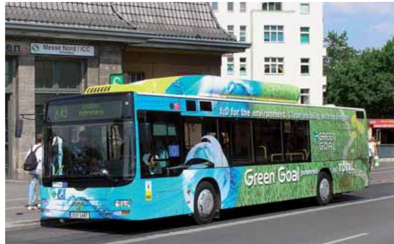
Von 2006 bis 2014 betrieb die BVG vier MAN NL 200 H2, die Wagen mit dem Saugmotor H 2876 UH haben sich bewährt. Die Verfügbarkeit lag bei 92 %, der Verbrauch zwischen 20 kg und 24 kg Wasserstoff auf 100 km; im selben Einsatzprofil benötigte ein Dieselbus etwa 42 l. Foto: Frank Interthal
