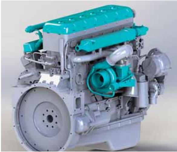
**Folgende Teile wurden am Deutz TCD geändert (von oben links nach unten rechts farblich hervorgehoben): Wasserstoffleitung, Einspritzdüsen, Einlasskrümmeradapter, Zündmodul, Hülse für Zündkerze, Zündmodulverlängerung und Zündkerze.**
