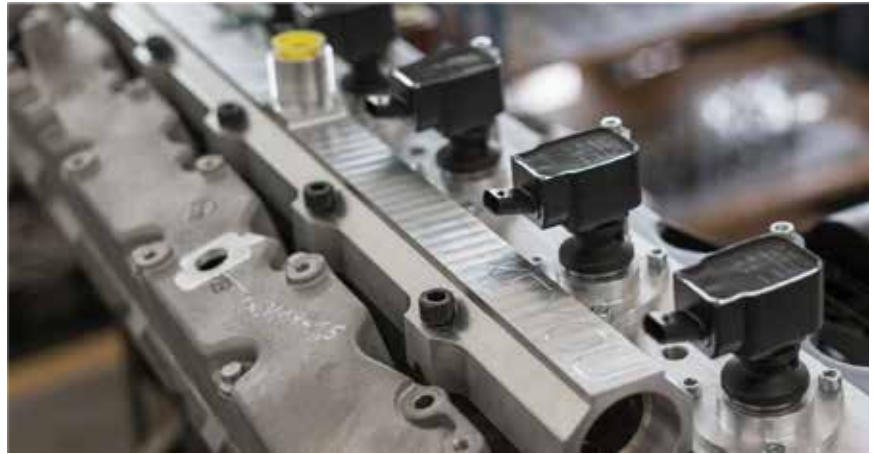
De nieuwe kop zoals Keyou die ontwikkelde voor de Deutz-motor, met duidelijk zichtbaar de centraal geplaatste ontsteking.
