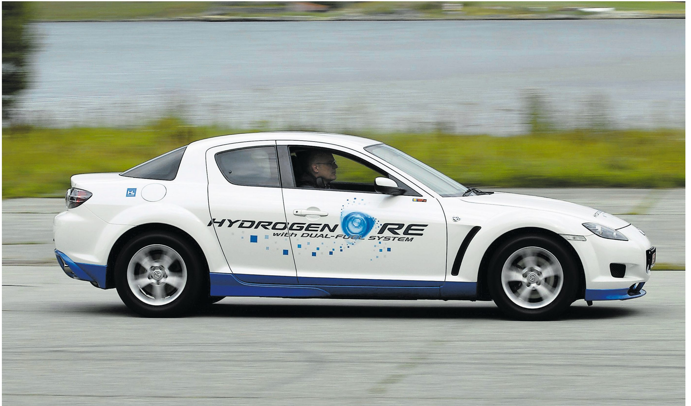
Mit einem Wasserstoff-betriebenen Wankelmotor hatte Mazda beim RX-8 Hydrogen RE keinen Erfolg.
