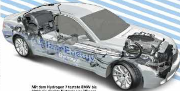
Mit dem Hydrogen 7 testete BMW bis 2009 die direkte Nutzung von Wasserstoff im Verbrennungsmotor. Der riesige Tank kündigt von den Problemen bei der Speicherung von H 2 .
