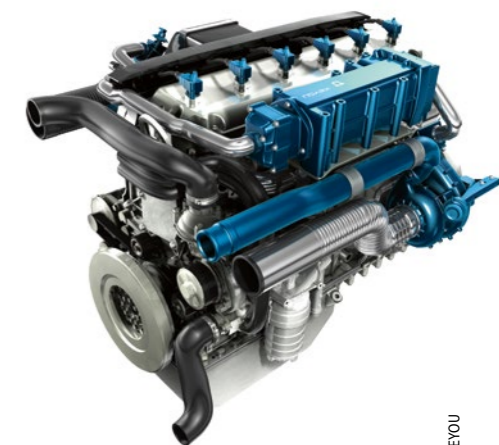
So könnte er aussehen: ein H 2 -Motor mit Komponenten von KEYOU
